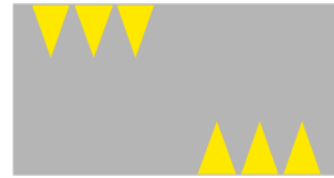
Z 6b Stavebný spomaľovací prah (označenie)
