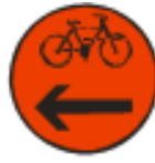
S 7d Signál pre cyklistov s červeným svetlom pre jeden smer so znamením „Stoj!“ (vzor)
