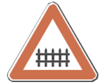
A 25 Železničné priecestie so závorami
